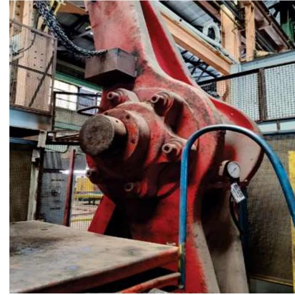
Principio de funcionamiento: Basado en la ley de Pascal, utiliza fluido hidráulico para generar altas presiones que se transmiten al pistón principal.
