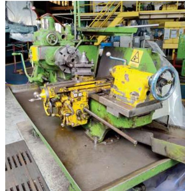
El torno horizontal Warner & Swasey M1420, serie 560968, es un equipo robusto de mecanizado utilizado en la industria para el torneado de piezas metálicas de mediano a gran tamaño.
